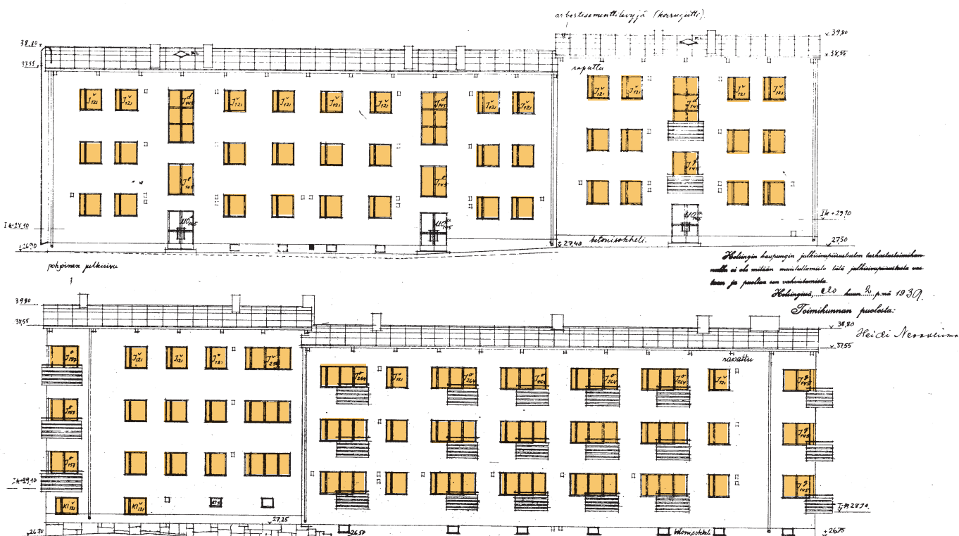
Olympiakylässä perinteisen rakentamisen piirteitä ovat esimerkiksi julkisivujen rauhallinen aukotus ja harmoninen suhdemaailma. Kuva OTK, Työväen museo Werstas, alkuperäinen piirustus rakennusvalvontaviraston arkisto
